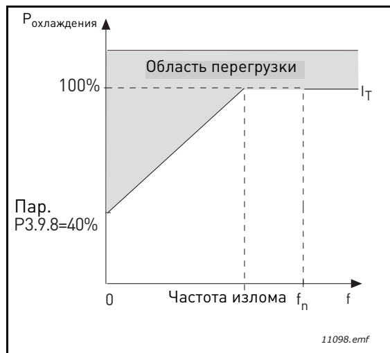
Рис. 26. Кривая теплового тока двигателя I_T
